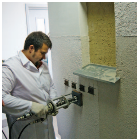
Эксперимент по определению адгезии накрывных слоев
