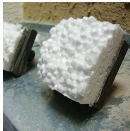
По окончании испытаний накрывные слои СФТК LITOTHERM полностью сохранили адгезию к утеплителю
